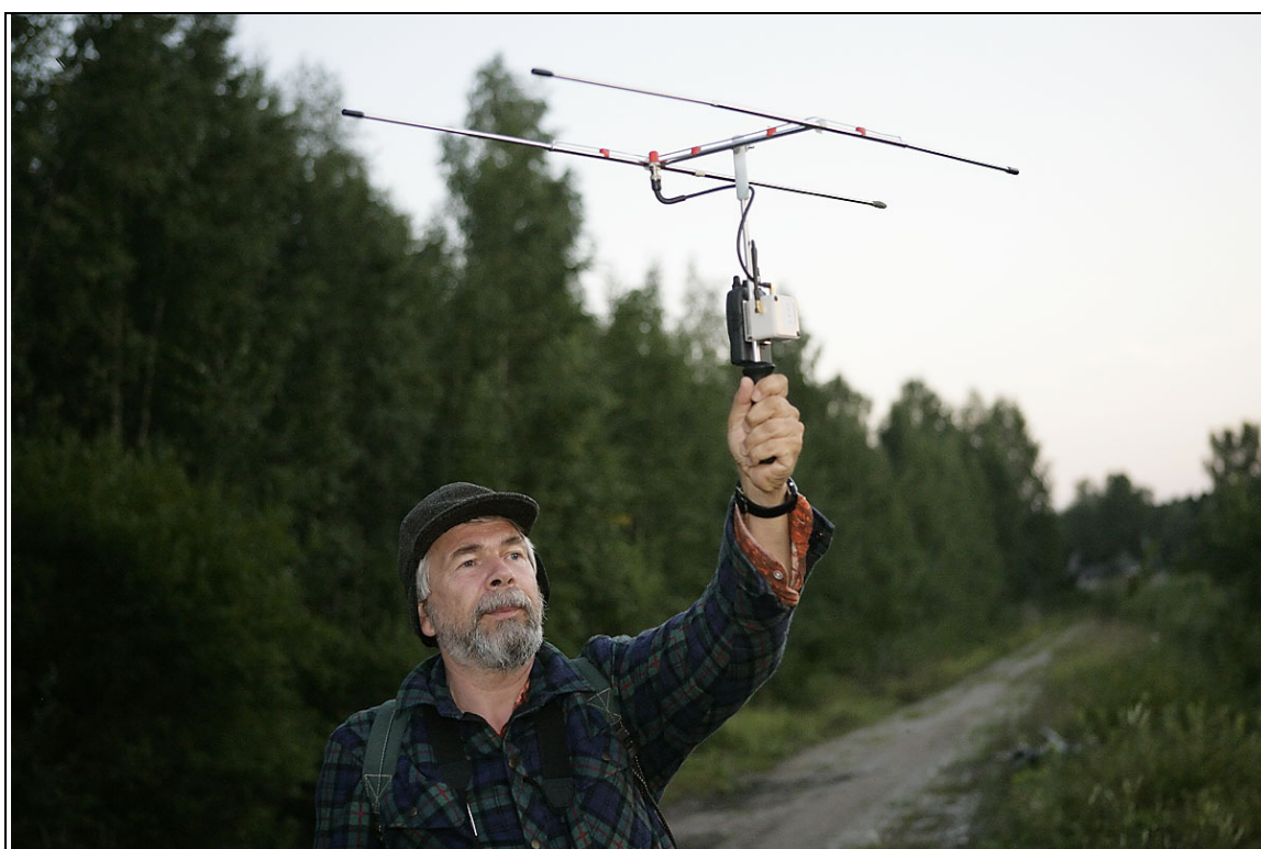
Joonis 1.5. Raadisaatjaga märgistatud sookure asukoha väljaselgitamine käsi-raadiopeilingaatoriga VR-500 (autoriõigus: Arne Ader).
